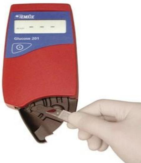
O **fotómetro Hemocue™** é o instrumento mede a absorção da luz e apresenta os resultados no visor. O fotómetro pode ser operado em segurança entre 15 a 40°C (59 á 104°F). Protege-lo sempre contra a directa luz do sol. Permita que o instrumento esteja a temperatura ambiente antes de inserir uma lâmina de análises.
