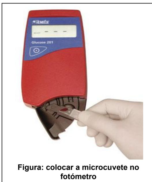
**Figura: colocar a microcuvete no fotómetro**
